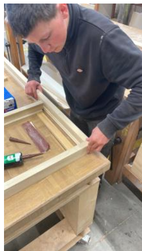
Even een foutje oplossen ☺ Onze wanden waren niet even hoog en moesten deze aan 1 zijde 1 cm inkorten.
