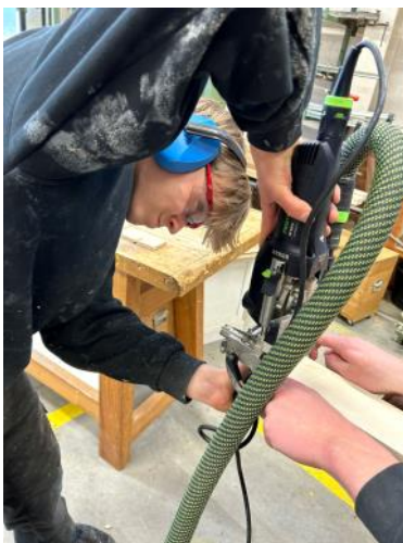
Ondertussen is de volgende groep gestart met het maken van topping(plafond). Dit gaan we niet met metalstuds maken maar met een houten constructie met overschotten van multiplex. Hier maken we verbindingen met de Domino.
