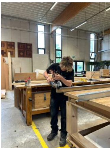
Even een foutje oplossen ☺ Onze wanden waren niet even hoog en moesten deze aan 1 zijde 1 cm inkorten.
